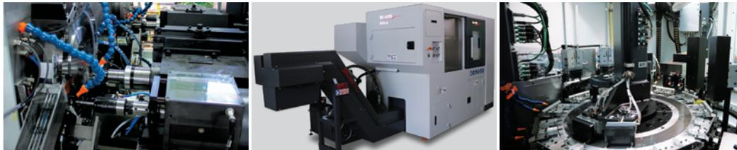
オートマティックコンバインマシン：冷間鍛造品の2次加工
