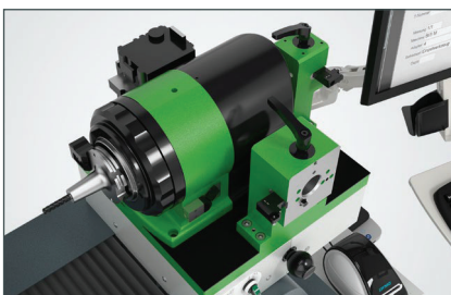
回転テーブルには、三辺にホルダーユニット/スピンドルユニットを搭載可能
