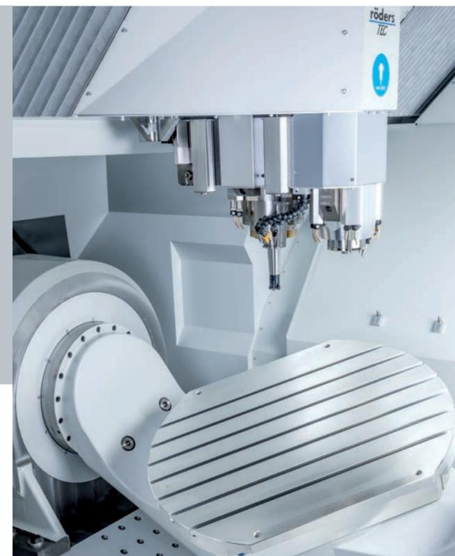
両方のスピンドルの軸は互いに近距離にありますが、スピンドルは複数の冷却回路により高精度の温度管理がされています。これにより両スピンドル間の距離とスピンドルの位置が絶対的に一定であることを確実にします。その結果として、両方のスピンドルが使用されるアプリケーションでは、ワークピースの原点の非常に高い同一性が達成されます。2つのスピンドルが1つのワークピースのセットアップに使用されます。
