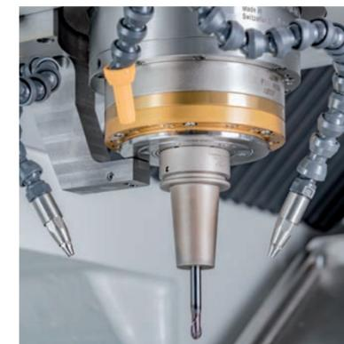
スピンドル伸びの外部センサーによる補正
