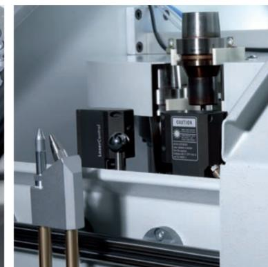
ツールチェンジャー内に設置されたレーザー測定装置
