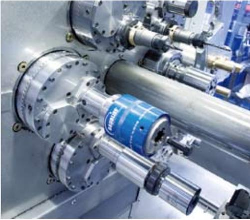
エンドツール加工ユニット1つに対して2つのツールを使用することができます。ツールは固定ツールでも回転ツールでも、またこれらのツールを組み合わせてもかまいません。これらはあらゆるスピンドル位置で使用でき、いつでも交換やレトロフィットが可能
